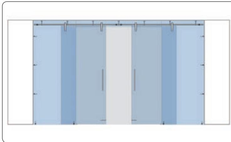
Typ 14 zweiflügelig, Deckenanschluss, 2 x Seitenteile, Oberlicht
